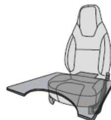
(DE) Matratze einlegen: Die klappbare Matratze zwischen die Vordersitze legen, aufklappen und in Pfeilrichtung auf den Unterbau legen, so dass die Vorderkante der Matratze unter das Lenkrad rutscht ...
