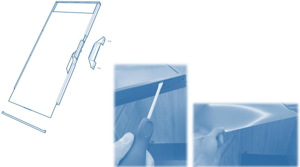
Wenn die Magnetfolie angebracht worden ist, dann können die Endstücke wieder angebracht werden und die Türe in die Kühlschrankfront eingehängt werden.
