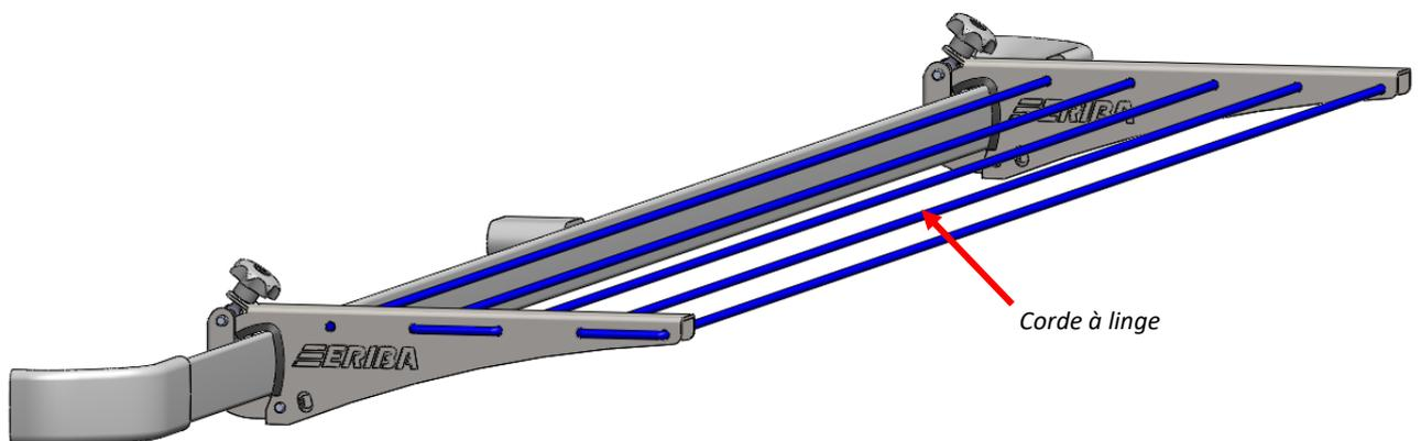
On peut régler la tension de la corde à linge en déplaçant latéralement un des bras.
