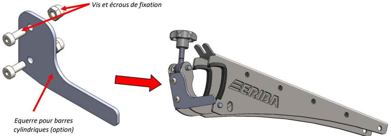
Montez cette équerre sur le bras vers l'extérieur, de façon à ce que qu'elle puisse s'appuyer sous le support de fixation de la barre de manoeuvre (liaison de la barre contre la caravane)
