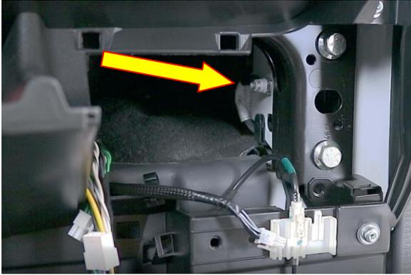
*Retirer l'écrou vissé ouverture de clé 10 mm.*
