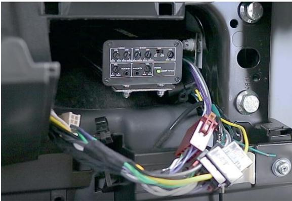
*Comme le montre la photo, monter l'amplificateur sur l'angle de montage (AMP V41 CampTec, câble de raccordement inclus) avec l'écrou d'origine doté d'une collerette et serrer fermement l'écrou.*
