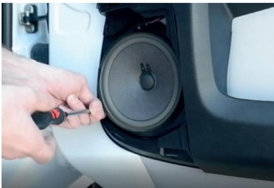
Retirer les vis du haut-parleur de graves, enlever ce dernier et débrancher le câble se trouvant sur le boîtier.
