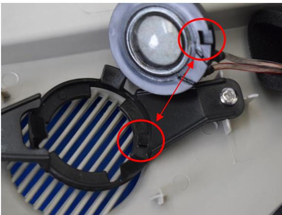
Raccorder le haut-parleur de graves JEHNERT, le clipser dans la fixation et le bouger dans la fixation jusqu'à ce qu'il atteigne le point d'arrêt.
