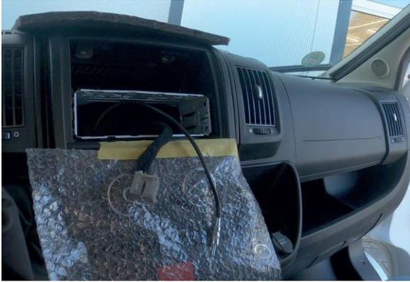
Enlever tous les câbles de raccordement se trouvant sur la radio et la mettre de côté.
