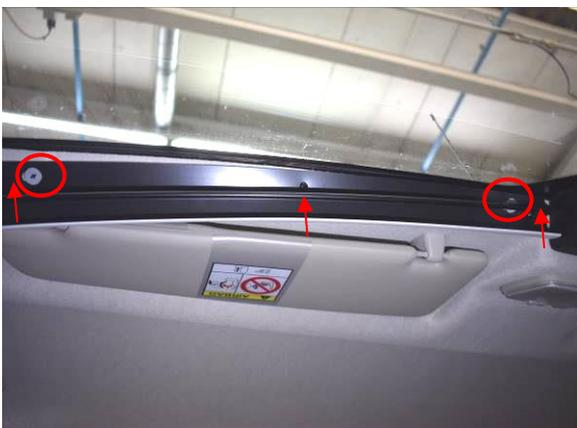
Détacher, de chaque côté, 2 vis en plastique et 3 vis à tôle se trouvant en haut dans le cadre du store REMIS.
