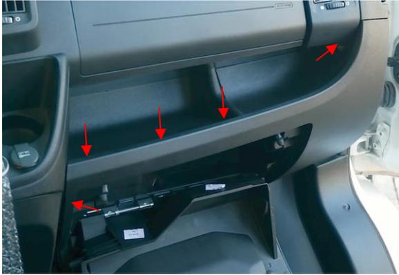
Retirer la vis se trouvant à l'intérieur, en bas sur la gauche sous la trappe de la boîte à gants ainsi que les vis se trouvant en haut dans l'habillage de la boîte à gants.
