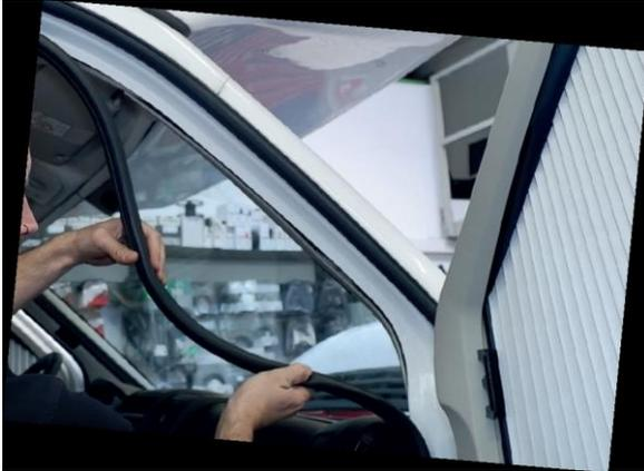
Détacher le caoutchouc du joint de porte dans la zone du montant A.
