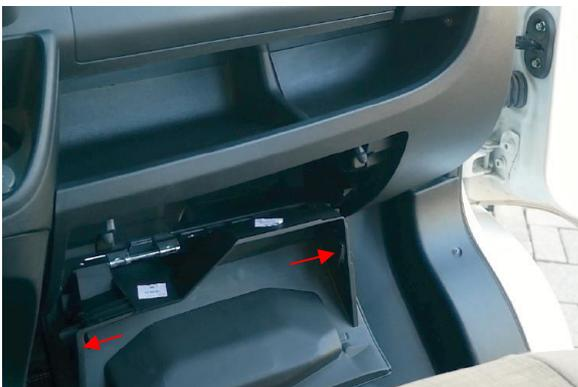
Ouvrir la boîte à gants et la déverrouiller en appuyant sur l'arceau situé latéralement à l'intérieur de telle sorte que celle-ci puisse être entièrement dépliée vers l'avant.
