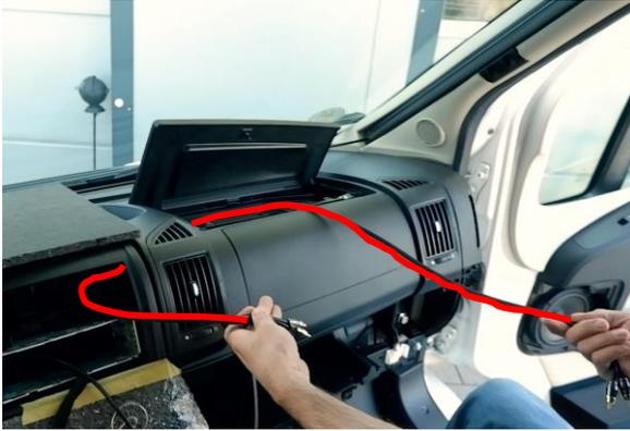
Tirer le câble adaptateur fourni de la console radio dans le compartiment de rangement.
