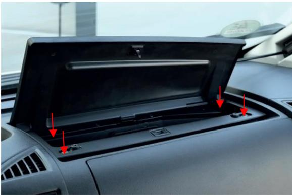
Ouvrir le compartiment de rangement et détacher les 4 vis se trouvant à l'intérieur et les mettre de côté.
