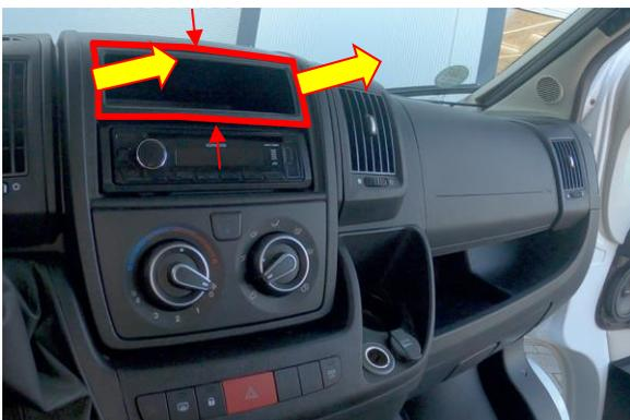
Retirer le compartiment de rangement situé au-dessus de la radio.
