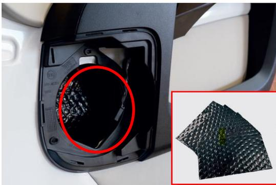
Retirer le papier de protection de la pièce jointe découpée en butyle alu. Chauffer le papier avec un sèche-cheveux et appuyer fort sur la tôle située derrière l'ouverture du haut-parleur de graves avec le côté du butyle (collant).
