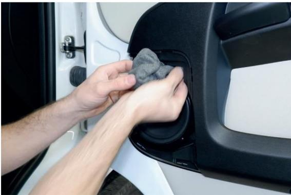
Pousser le tube en mousse au-dessus de la connexion embrochable et pousser-le par l'ouverture dans l'espace libre se trouvant sous l'habillage.
