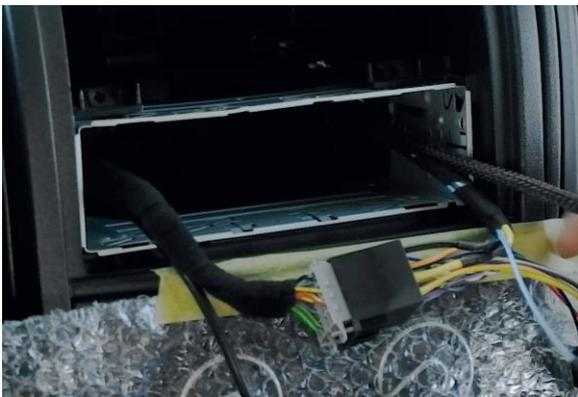
Relier le câble adaptateur à la radio et au connecteur DIN/ISO Fiat.
