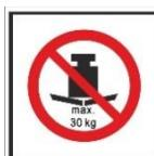
Alleen goedgekeurd voor een maximale belasting van 30 kg
