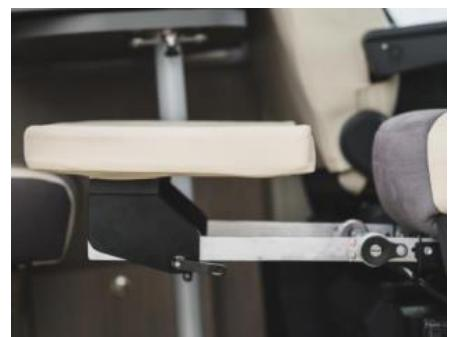
La superficie de apoyo puede ajustarse hasta una longitud máxima de 900 mm desplazando el cojín tapizado verticalmente sobre las bisagras. Para ello, las bisagras deben estar enrasadas con el dispositivo de sujeción
