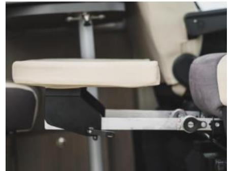
Durch vertikales Verschieben des Polsterkissens auf den Gelenkscharnieren können die Auflagefläche bis zu max. 900 mm Länge eingestellt werden.
