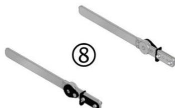
Kun asetat saranat (8) tukirakenteen koukuun (9), varmista, että sivuilla olevat mustat metallilevyt (10) osoittavat aina ulospäin. Ei istuimen keskelle.
