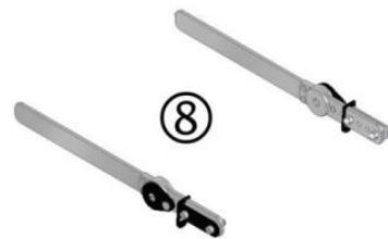
Beim Einsetzen der Gelenkscharniere (8) auf den Haken (9) der Trägerkonstruktion achten, dass die seitlichen schwarzen Metallplatten (10) immer nach außen zeigen. Nicht zur Sitzmitte.
