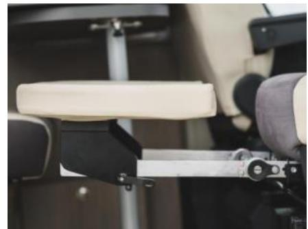
Stödytan kan justeras upp till en maximal längd på 900 mm genom att flytta den stoppade dynan vertikalt på gångjärnen.
