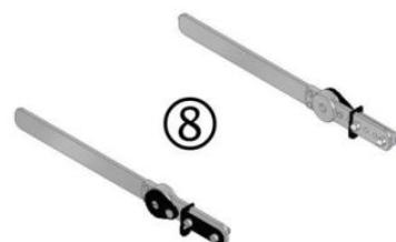
Lors de la mise en place des charnières articulées (8) sur le crochet (9) de la structure porteuse, veiller à ce que les plaques métalliques noires latérales (10) soient toujours orientées vers l'extérieur. Pas vers le centre du
