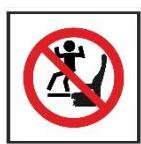
Není povoleno bodové zatížení, jako je stání nebo skákání na opěrce nohou.
