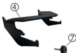
La estructura de soporte (4) debe colocarse entre los travesaños (5) y (6).
