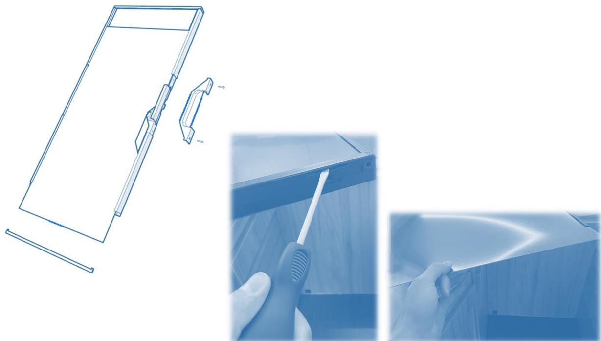
**(DE)** Wenn die Magnetfolie angebracht worden ist, dann können die Endstücke wieder angebracht werden und die Türe in die Kühlschrankfront eingehängt werden.
