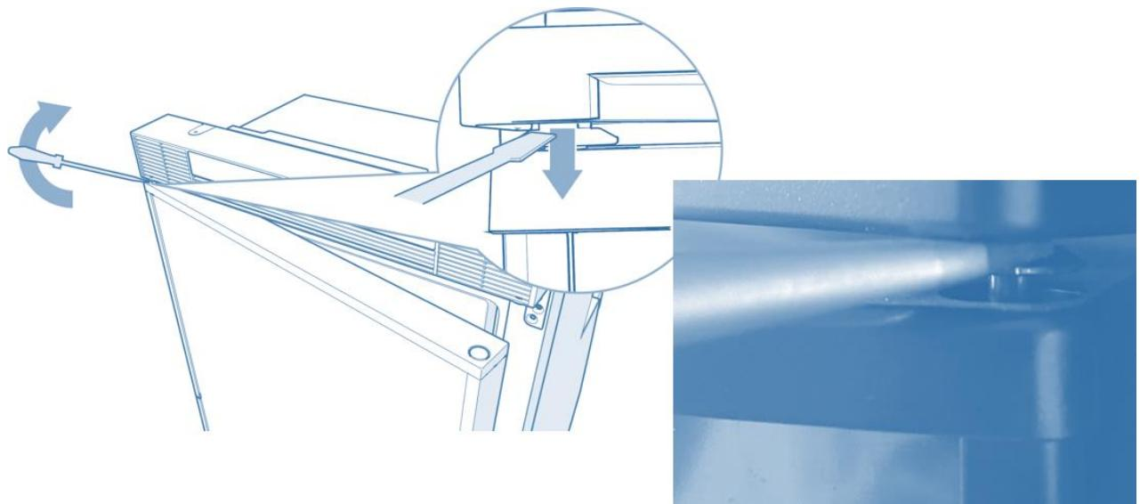
**(DE)** Nachdem der Verbindungsbolzen nach unten gedrückt worden ist, kann die Kühlschrankfront entnommen werden.
